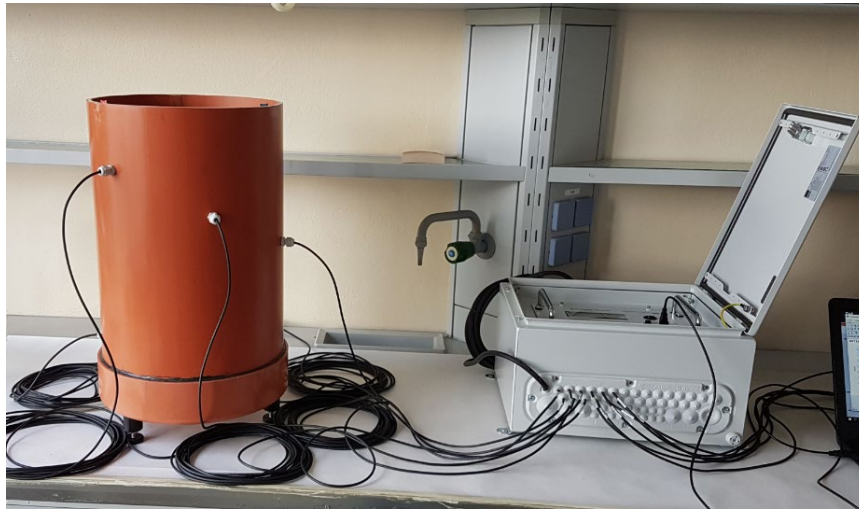
Abbildung 2: Säule mit spiralförmig angeordneten Feuchtigkeitssensoren und Datenlogger
