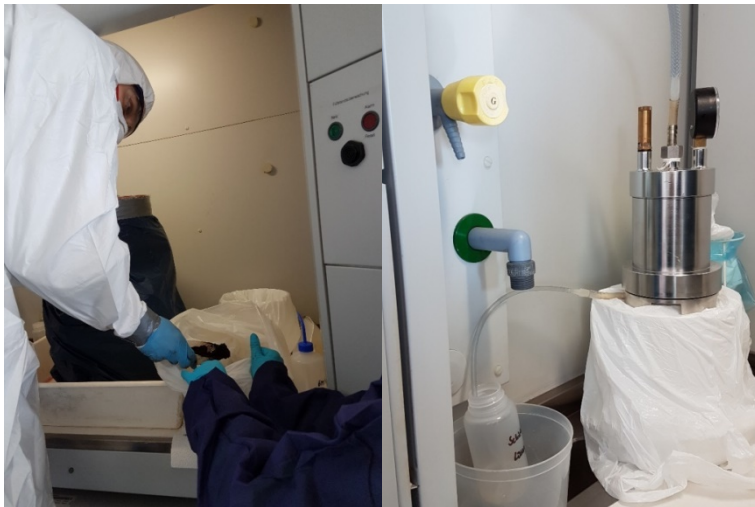
Abbildung 6: Schichtweiser Ausbau der Säule unter dem Abzug (links) und Abdrücken des Porenwassers mit Hilfe einer Edelstahl-druckfiltrationszelle (rechts)
